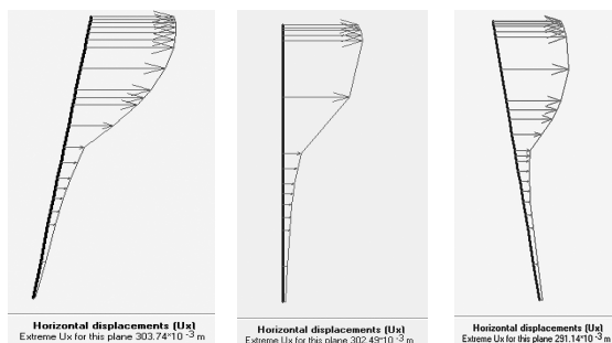
Hình 6. Chuyển vị ngang của cọc sau khi đóng.
